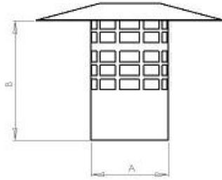
Utiliser pour terminer un système au sommet d'une cheminée de maçonnerie dans une application gaz.
